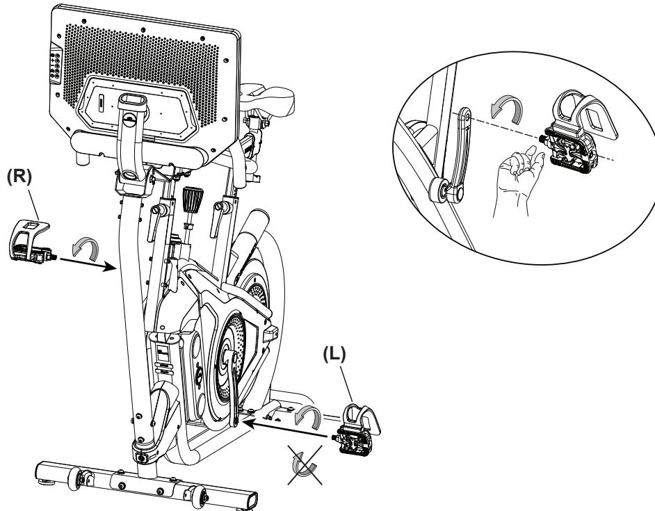
1. Inicie el pedal a mano. Si se nota resistencia y el pedal no gira suavemente en la biela, asegúrese de que las roscas estén alineadas correctamente. Asegúrese de que el pedal vaya directo a la biela. Si el pedal no está alineado con la abertura, quitelo y empíeze de nuevo.
