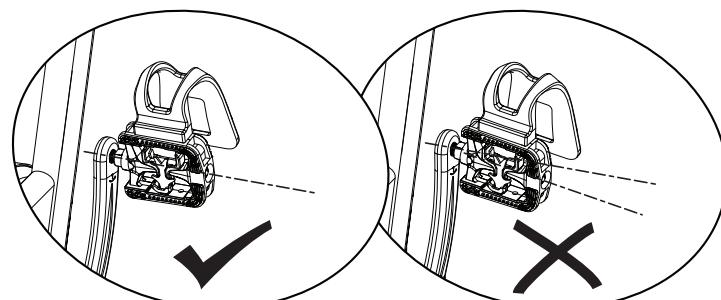
2. Dé varias vueltas al pedal con la biela y apriételo completamente con la llave 15 mm correspondiente.
